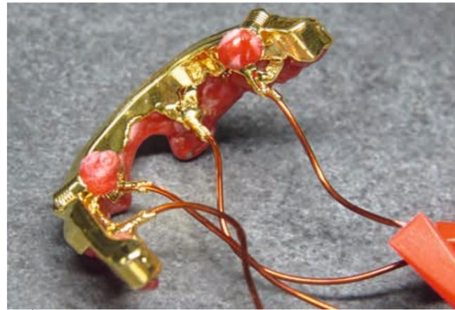
Abb. 18: Nach dem Galvanisierungsprozess
