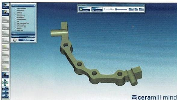
Abb. 7 Die Daten des vollständig konstruierten Steges können nun an die Motion 2 geschickt werden
