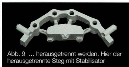
Abb. 9 ... herausgetrennt werden. Hier der herausgetrennte Steg mit Stabilisator
