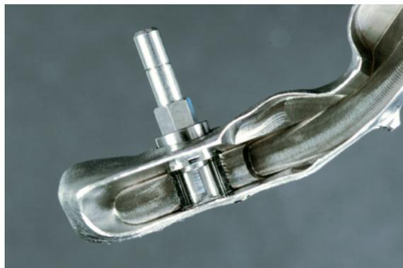
Abb. 14: Innenansicht der Sekundärstruktur mit eingearbeitetem Riegel-Attachment. Die Verbindung erfolgte durch Laserschweißen.
