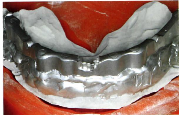
Abb. 14: Dupliertechnik zur Herstellung der Galvanoteile.
