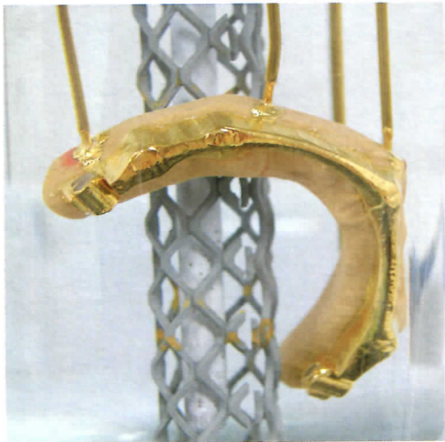
Abb. 18 Der Steg nach dem Galvanisieren im Goldbad
