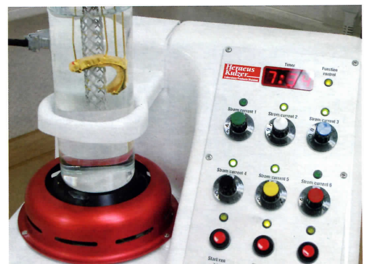
Abb. 17 Preciano CL-GF von Heraeus. Die Stromstärke wird der Steggröße entsprechend ermittelt (Bestimmungstabelle)
