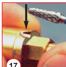
17 frezujemy zabezpieczające nacięcie na śrubie
