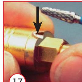
17 Sicherungskerbe am Schraubteil einschleifen
